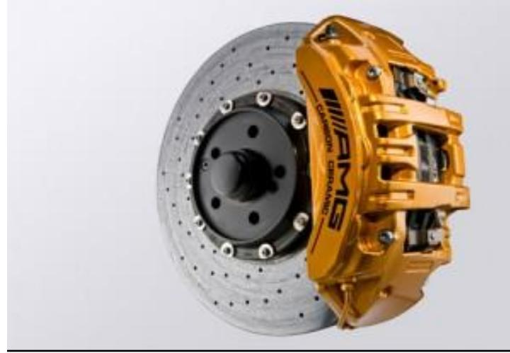
Οι δίσκοι από ανθρακονήματα είναι κατασκευασμένοι από γραφίτη ενισχυμένο από ένα πλέγμα ανθρακονημάτων. Ένας τέτοιος δίσκος χαρακτηρίζεται ως carbon-carbon. Η κατασκευή του είναι μια ακριβή και χρονοβόρα διαδικασία. Τα ανθρακονήματα είναι πολύ ακριβά και εκτός αυτού απαιτείται ψήσιμο σε ειδικό φούρνο για αρκετές βδομάδες κατά την οποία αυξάνει το κόστος ακόμη περισσότερο.
